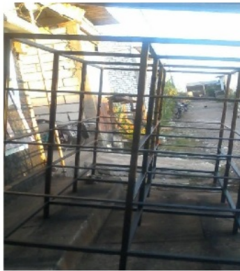
Gambar 2. Kerangka besi sebagai Rak di dalam Alat Pengering Terung/Teripang
