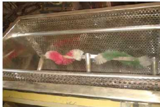
Gambar 1b. Mesin Pencuci Kulit Singkong (Tampak bagian dalam)
