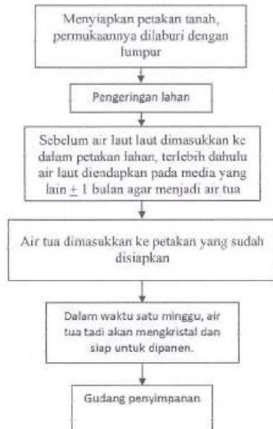
Gambar 2. Bagan alir proses produksi garam krosok (Sumber: Bapak Ridwan dan Faiz, petani garam krosok Kab. Gresik)
